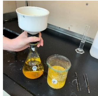
Figure 4. Montage de la filtration sur Büchner.
