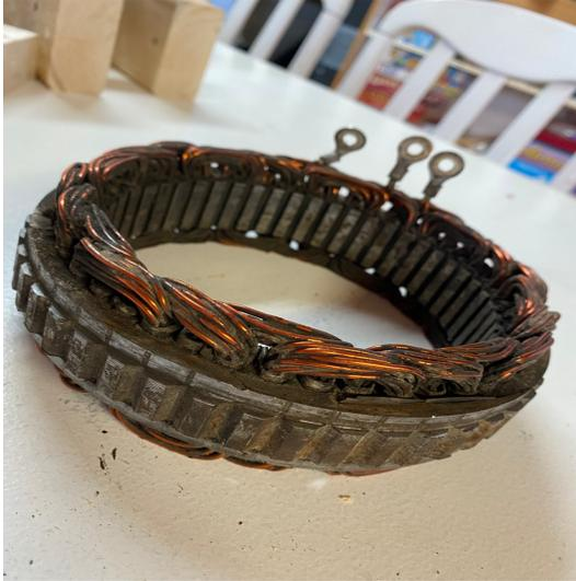
**Figure 7. Bobinage de l'alternateur de camion.**
